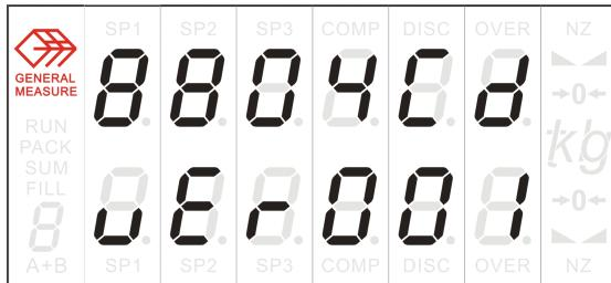
**停止状态：**初始上电仪表将进入这一状态，在此状态下，可进行系统标定，参数设定，配方管理及简单称重等，此时上下排显示分别为 **A** 秤和 **B** 秤的实时重量，副显示为配方号，如下图所示。**A** 秤当前重量为 **0.020kg**; **B** 秤当前重量为 **0.000kg**。当前配方为 **0** 号配方，该配方下设备工作在双秤组合工作模式。
